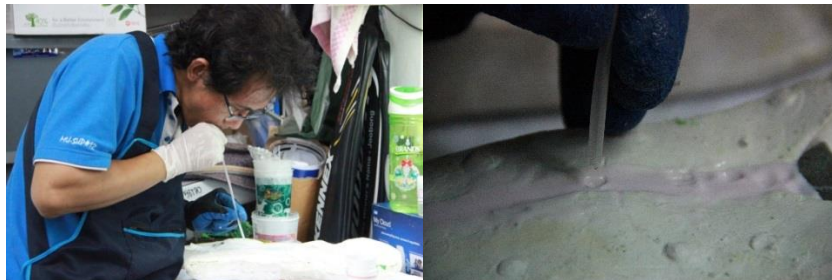
ภาพการใช้หลอดเป่าไล่ฟองอากาศ
